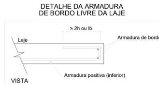
Armação positiva das lajes do pavimento Pavimento 1 (Eixo Y)
