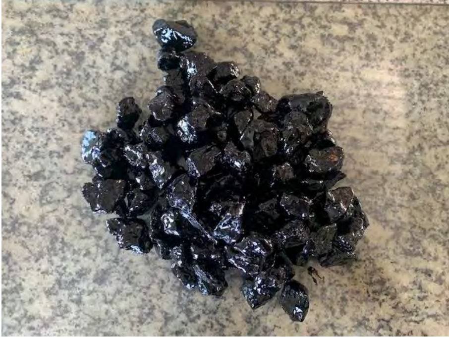
Imagem 03 – Amostra após a conclusão do ensaio, 1,0% fixador de película (Dope)
