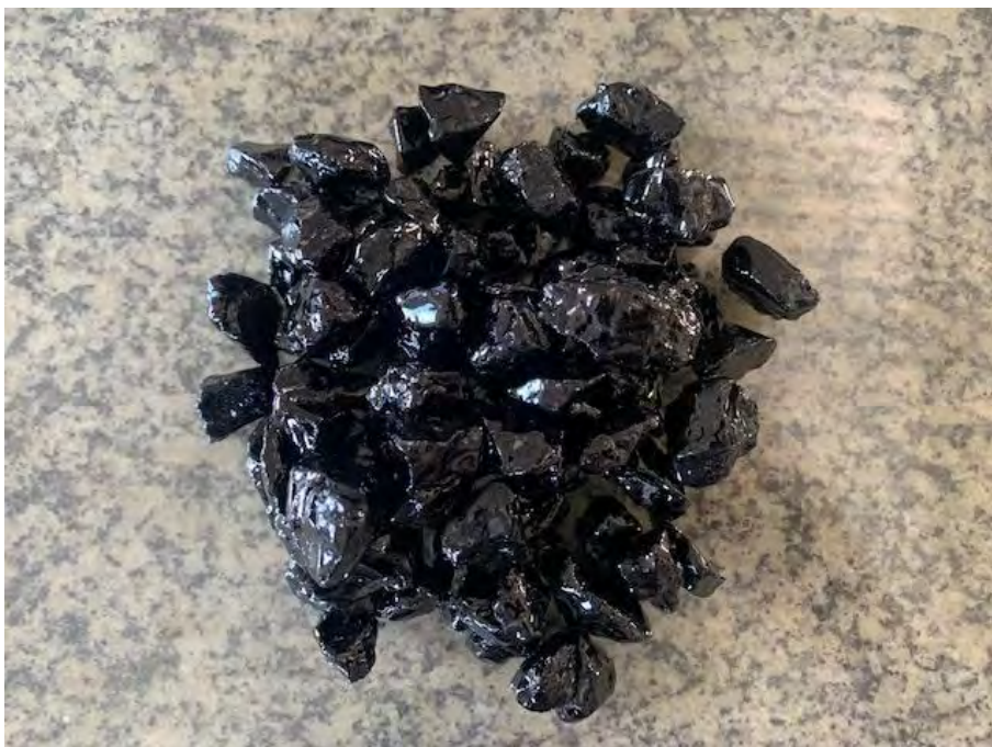
Imagem 02 – Amostra após a conclusão do ensaio, 0,5% fixador de película (Dope)
