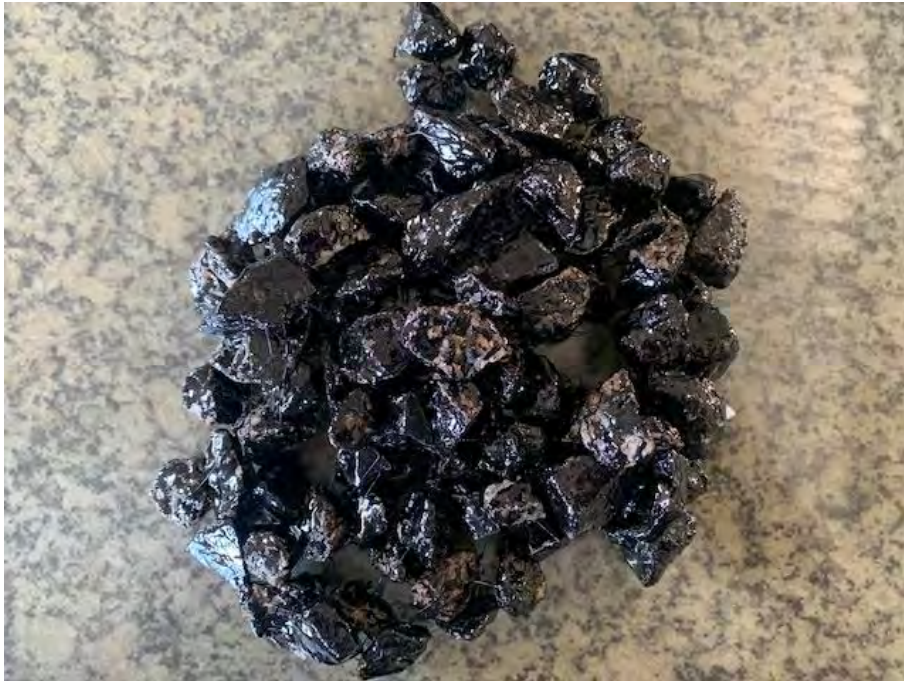
Imagem 01 – Amostra após a conclusão do ensaio, 0,0% fixador de película (Dope)
